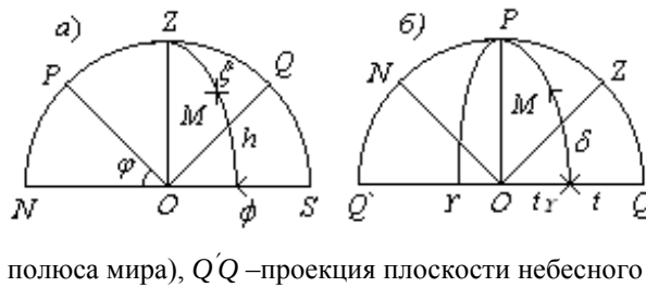
Рис. 7.4. Сферическая система координат: а) – земная, б) – небесная. NZS и Q'PQ – плоскости основных меридианов небесной сферы (воображаемой сферы с центром в точке наблюдения O ), OZ – местный вертикаль (отвесная линия), Z – точка зенита, NS – полуденная линия ( N – точка севера и S – точка юга), OP – полярная ось видимого вращения небесной сферы ( P – точка северного полюса мира), Q'Q – проекция плоскости небесного экватора.
