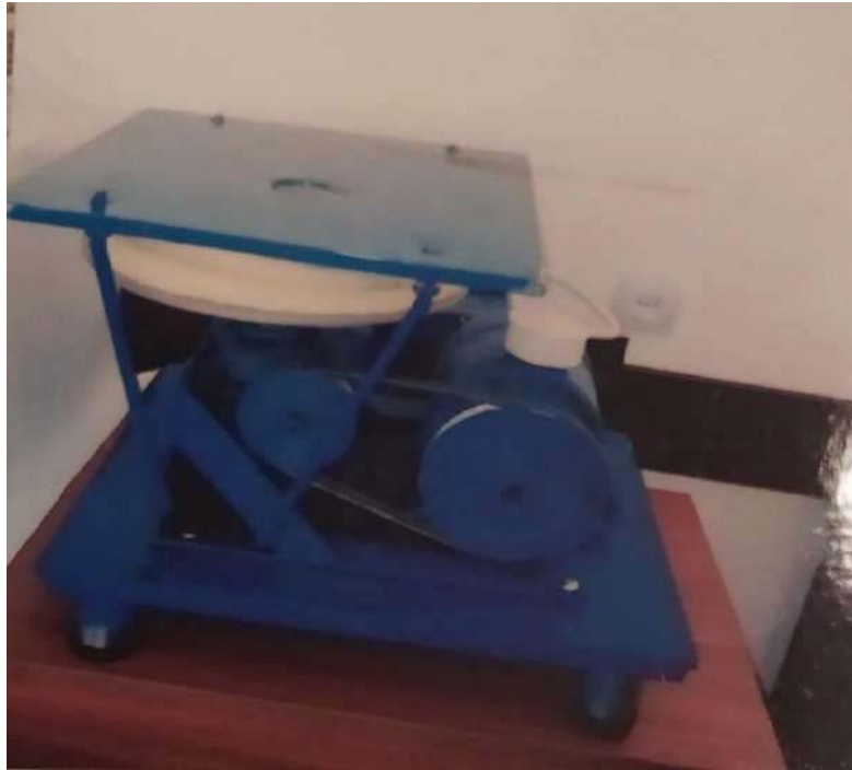
Şəkil 1. Lifli pambıq çiyidlərinin kombinə edilmiş “ADAU” üsulu ilə çeşidlənməsi üçün Kirkirə formalı qurğunun ümumi görünüşü.
